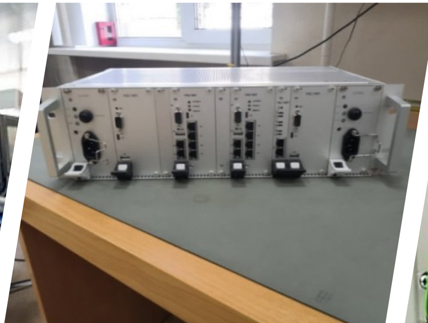
Центральное процессорное устройство ЦПУ-ЭЛ-20
